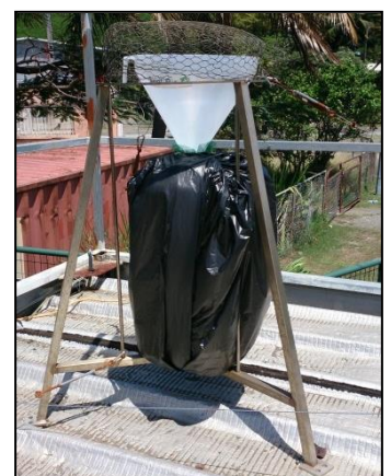
Figure 2 : Jauge Owen installée sur le toit de la station de Montravel
